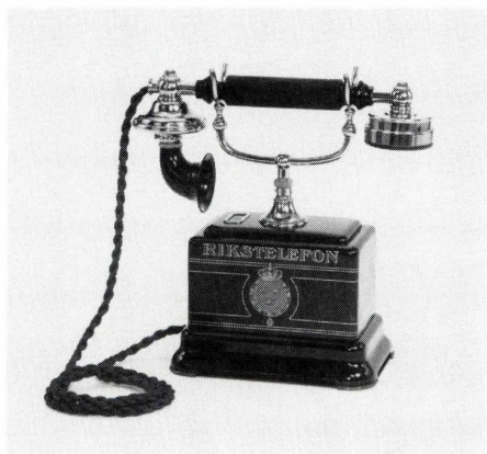
10. Telefonapparat i plåt för centralbatterisystem, 1910.
