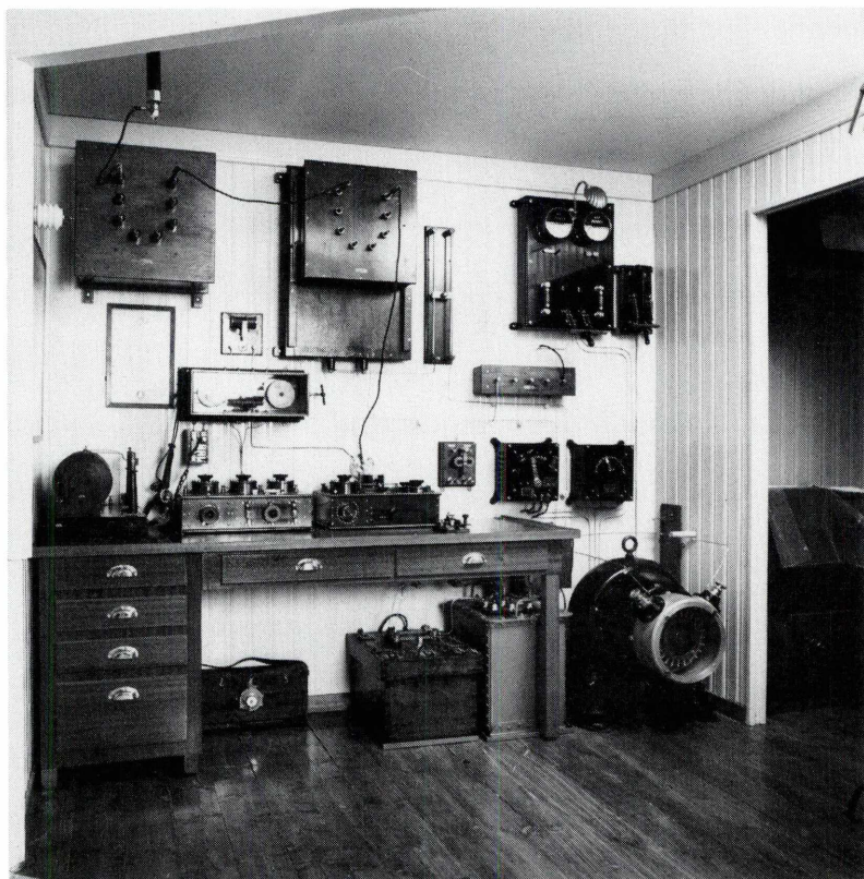
9. Fartygsradio med gnistsändare, typ Marconi, 1912.
