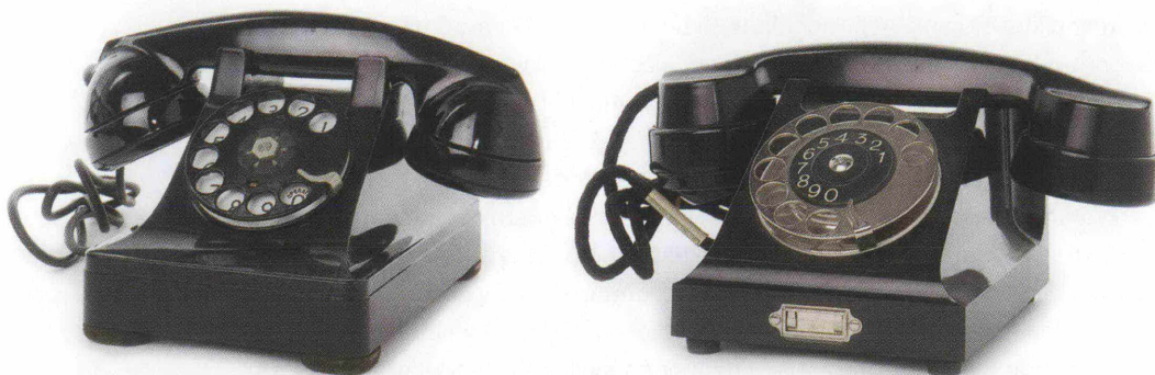
Vänster: Bells Model 302 i design av Henry Dreyfuss och i produktion 1936 (TeM 42759). Höger: Likheterna med Ericssons bakelittlefon är slående, särskilt den mindre varianten DE752 från 1933. Tekniska museets samlingar (TeM 60895).
